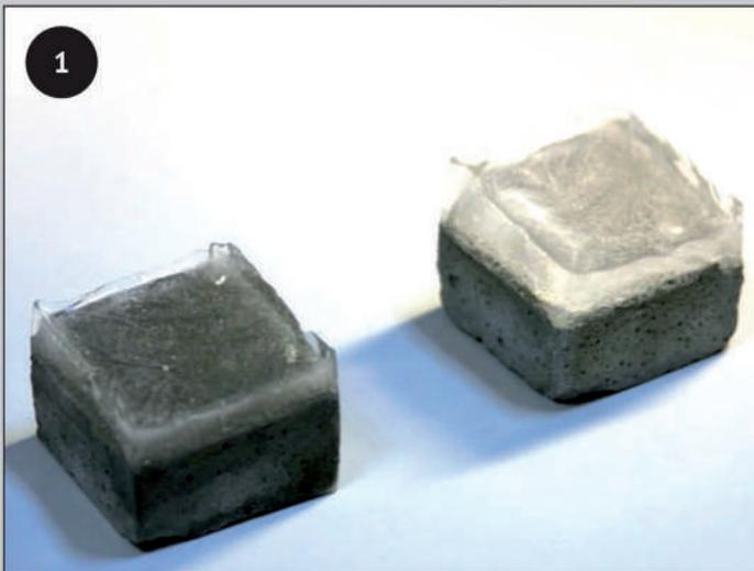
Правый кубик был обработан гидрофобизатором Типром У1. Затем оба кубика покрыли слоем льда.
